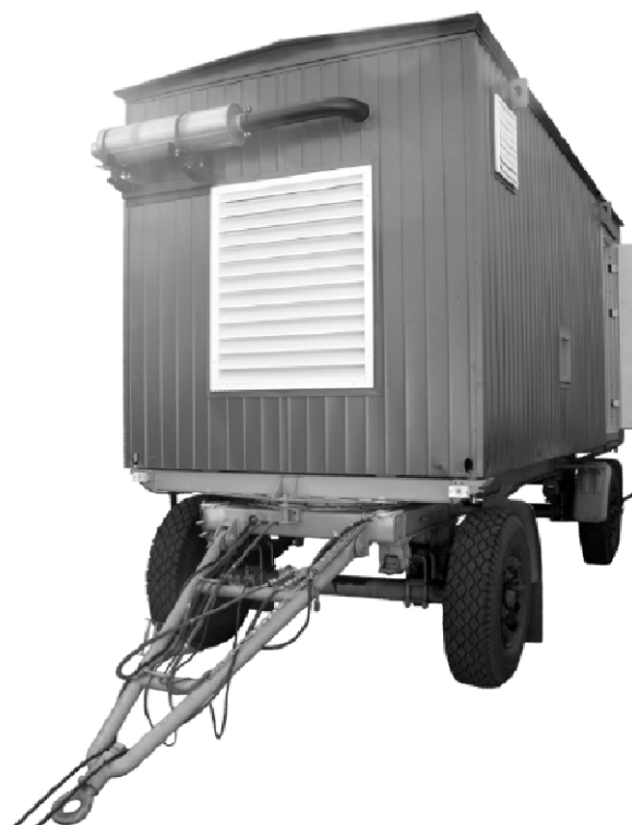
Рисунок 2.10 – Электроагрегат в контейнере на двухосном прицепе ВМЕ 8915
